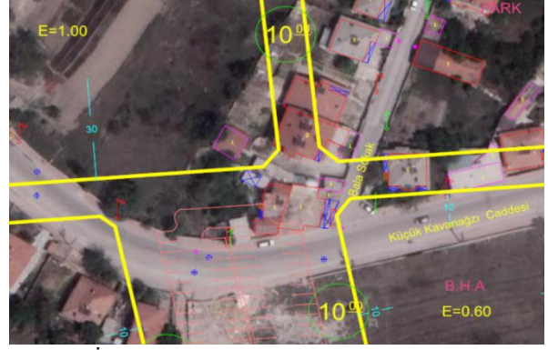
Şekil 6. İmar yolu üzerinde bulunan imara aykırı yapılar.
