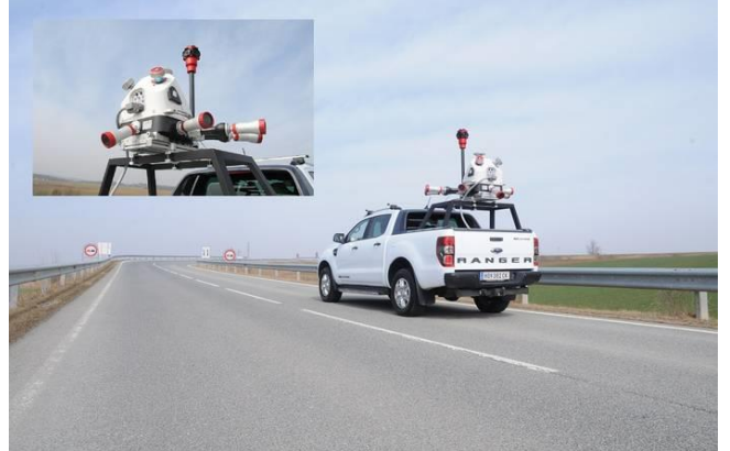
Şekil 2. Yüksek Hızlı, Yüksek Performanslı & Çift Tarayıcı Mobil Haritalama Sistemi RIEGL VMX-2HA
