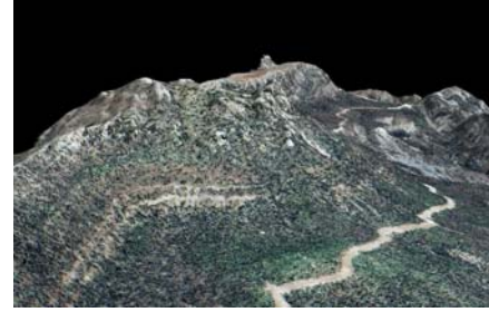
Şekil 6. Sayısal yükseklik modeliyle yüksek çözünürlüklü uydu görüntüsünün birleşmesi sonucu oluşan sanal platform
