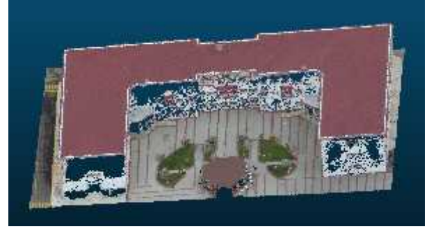
ekil 1. Labratuvar binasına ait gerçek renkli nokta bulutu.
