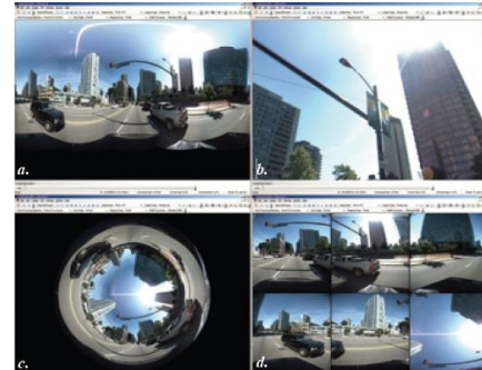
Şekil 3. (a) Panoramik görüntü, (b) Küresel görüntü, (c) Kubbe görünümü (d) Çoklu kamera görünümü
