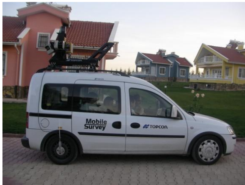
Şekil 6. Topcon IP-S2 mobil haritalama sistemi
