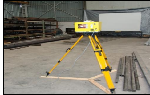
Şekil 2. Uygulamada kullanılan Optech Irlis 3D lazer tarayıcı
