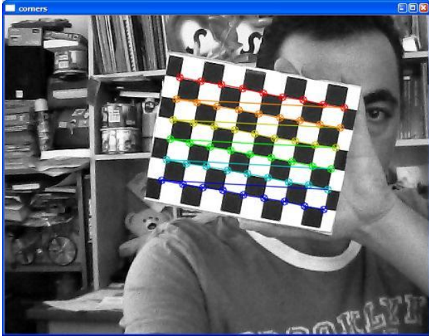
Şekil 5.2. Belirlenen kontrol noktaları.
