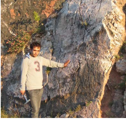
Şekil 3.2: Permo-Triyas Yaşlı Tokat Karışığına Ait Mermerler İçerisinde Gözlenen ve Kazova Havzası'nı Güneyden Sınırlayan Tokat Fay Setine Ait Normal Fay Düzlemi.
