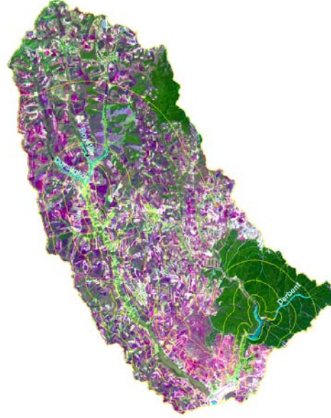
Şekil 2. Sazlıdere Su Havzası'nın, 1992 tarihli Landsat-5 TM, SPOT-Pan uydu verileri ile çakıştırılarak oluşturulmuş renkli görüntüsü ile su havzası koruma bantları ve derelere ait vektör datanın CBS bindirme uygulaması ile oluşturulmuş sonuç görüntüsü .
