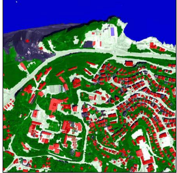
Şekil 13. 2004 QuickBird görüntüsü kullanılarak elde edilen nesne-tabanlı sınıflandırma sonucu (Kırmızı: Bina yapıları) (Marangoz, 2009)
