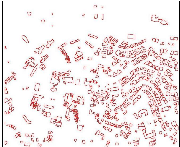
Şekil 14. 2004 QuickBird görüntüsü kullanılarak elde edilen nesne-tabanlı sınıflandırma sonucu (Kırmızı: Bina yapıları) (Marangoz, 2009)
