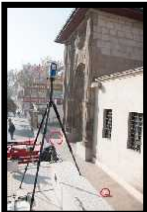
ekil 4. Lazer Tarayıcı ve Özel Yansıtıcı Küre Hedefler
