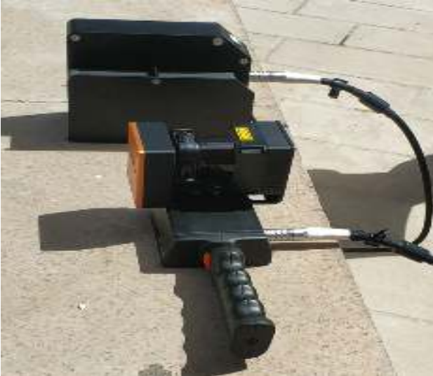
Şekil 2. “Geoslam” lazer tarama cihazı
