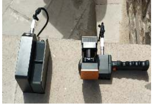
Şekil 3. “Geoslam” lazer tarama cihazı
