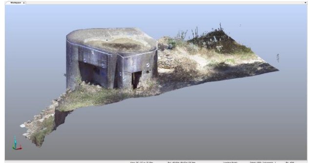
Şekil 7. Korugan nokta bulutu görüntüsü
