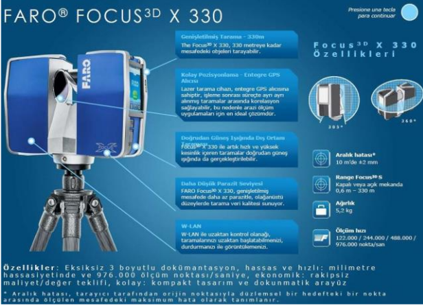
Çizelge 1. Faro Focus3D X 330 Yersel lazer tarayıcının genel özellikleri (Hepyörük,2015)
