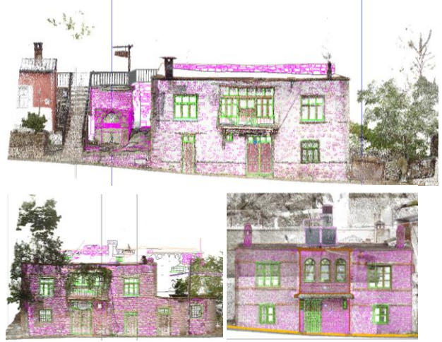
Şekil 6. Nokta bulutu atlığında sokak cephe çizimleri
