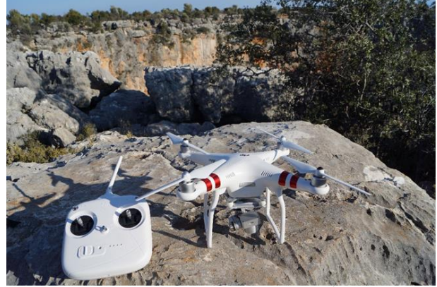
Şekil 2.2. DJI Phantom 3 Standard İHA
