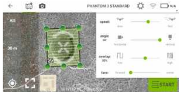
Resim 5. Pix4D Capture ile Uçuş Planlaması
