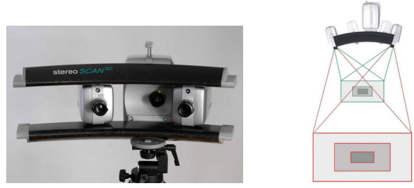
Şekil 7a ve 7b. Breuckmann StereoSCAN 3D ve kamera yerleşimi
