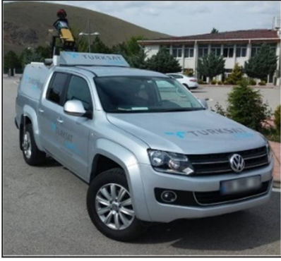
Şekil 2. Topcon IP-S2'nin ML sistemi araç ve ekipmanlar
