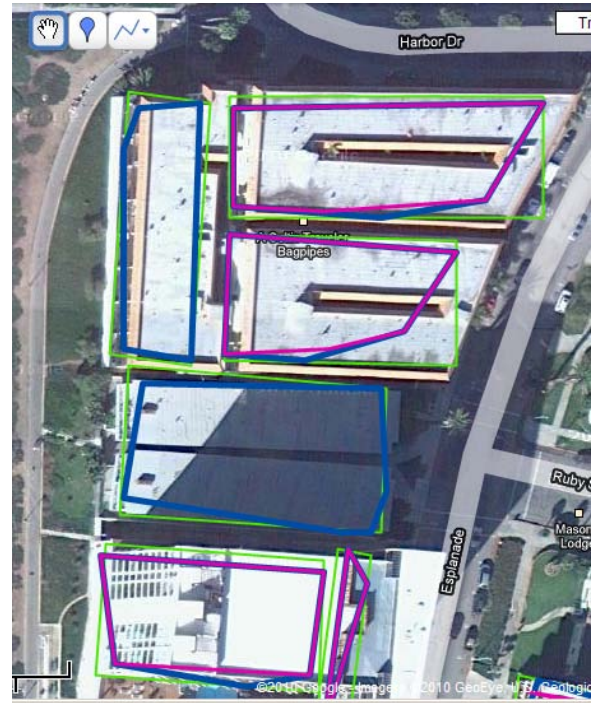
Şekil 8: Elde edilen bina çerçevesinin görüntü ile eşleştirilmesi
