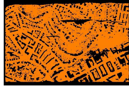
Şekil 3. TerraScan ile elde edilen arazi noktaları
