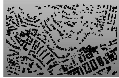
Şekil 4. TerraScan ile elde edilen bina noktaları
