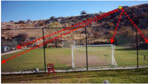
Şekil 9. Engelsiz alandan engelli alandaki detayların ölçülmesi
