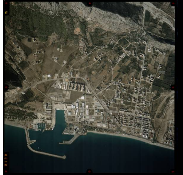
Şekil-4: Dijital (Sayısal) Fotogrametrik Sistemde Stereo Hava Fotoğraflarından Üretilmiş Sayısal Bir Ortofoto
