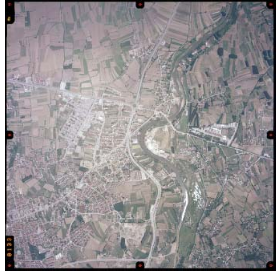
Şekil-6: Sayısal Görüntü İşleme Sisteminde Monoskopik Hava Fotoğrafından Üretilmiş Sayısal Bir Ortofoto
