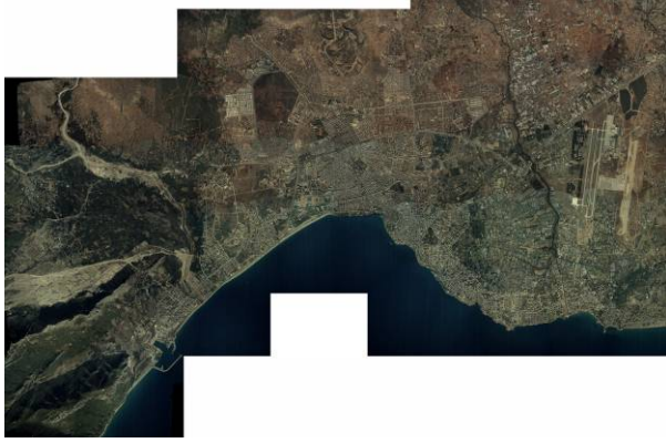
Şekil-5: Dijital (Sayısal) Fotogrametrik Sistemde Stereo Hava Fotoğraflarından Üretilmiş Bir Ortofoto Mozaik
