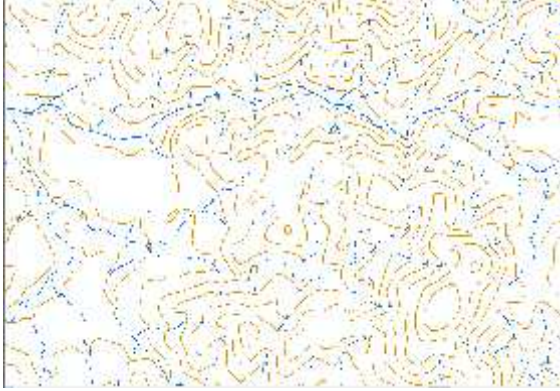
ekil 11. Çanakkale Bölgesinde SRTM 30m Verisinden Üretilen E Yükseklik E rileri ve Dere Uyumu
