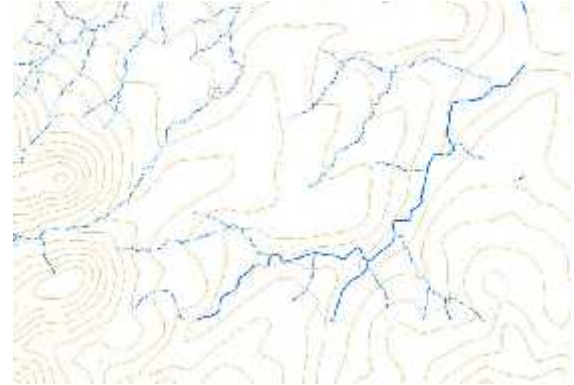
ekil 9. Çanakkale Bölgesinde SRTM 90m Verisinden Üretilen E Yükseklik E rileri ve Dere Uyumu
