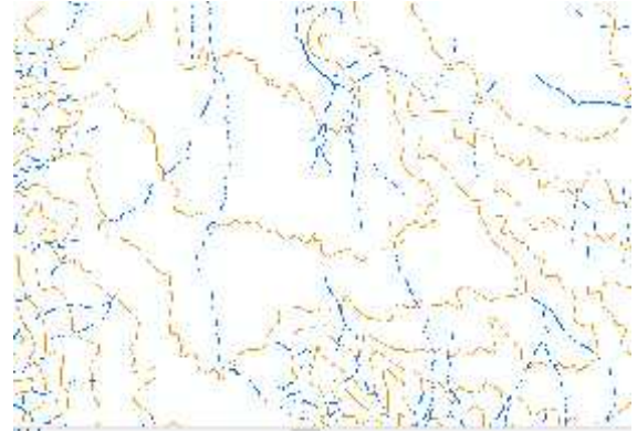
ekil 14. Konya Bölgesinde ALOS 30m Verisinden Üretilen E Yükseklik E rileri ve Dere Uyumu
