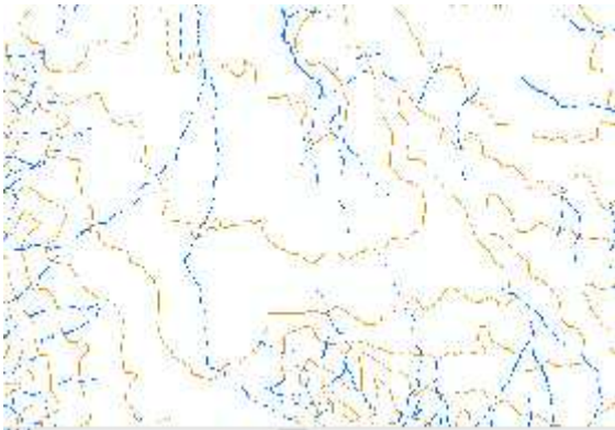
ekil 12. Konya Bölgesinde SRTM 30m Verisinden Üretilen E Yükseklik E rileri ve Dere Uyumu
