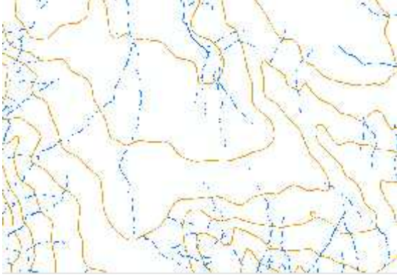
ekil 10. Konya Bölgesinde SRTM 90m Verisinden Üretilen E Yükseklik E rileri ve Dere Uyumu
