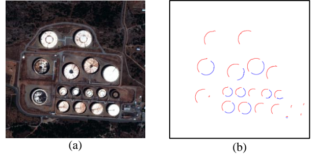
Şekil 3. (a) GeoEye-1 görüntüsü, (b) aday eğri parçaları. Dairesel nesnenin dış kısmına ( S_o ) ve iç kısmına ( S_i ) ait bulunan eğri parçaları sırasıyla kırmızı ve mavi renkle gösterilmiştir. Böylece verilen d_r = \{-d, -d+1, \dots, d-1, d\} şeklindeki bir girdi için arama alanının tüm pikselleri Eş. (6) ile hesaplanabilmekte ve \delta_{oj}^c eğrisi için arama alanı ( s_{\mathfrak{D}}^{oj} ) oluşturulmaktadır (Şekil 4). Devamında arama alanı içerisinde (bir veya daha fazla) \delta_{ij}^c eğri parçası bulunursa \delta_{oj}^c ve \delta_{ij}^c karşılıklı eğri parçaları olarak etiketlenmekte ve dairesel nesnenin sınırları bu eğri parçaları beraber kullanılarak yine (Taubin, 1991) yöntemi kullanılarak tahmin edilmektedir.
