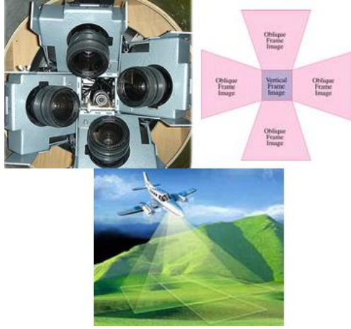
Şekil 3. 5 kameralı sistem (Petrie, 2008)
