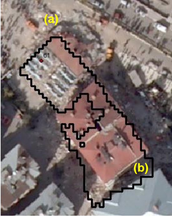
Şekil-11. Stereo Fotoğraflardan Tespit edilen (a) ve Tespit Edilemeyen Bina (b)- Her İki Bina YM Farkları Alınarak Otomatik Olarak Tespit Edilmiştir.
