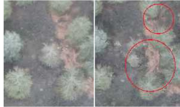
ekil 12. a) Orijinal görüntü ve b) Ortofotoda bozuk alanlar
