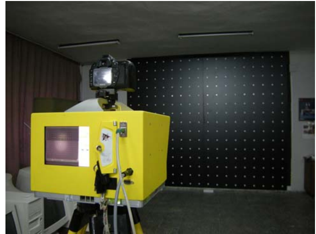
Şekil 1. YLT ve kamera birleşiminde KKP'nin hesaplanması için yapılan ölçmeler. Test alanının lazer tarayıcı ile taranması ve fotoğraf çekimi
