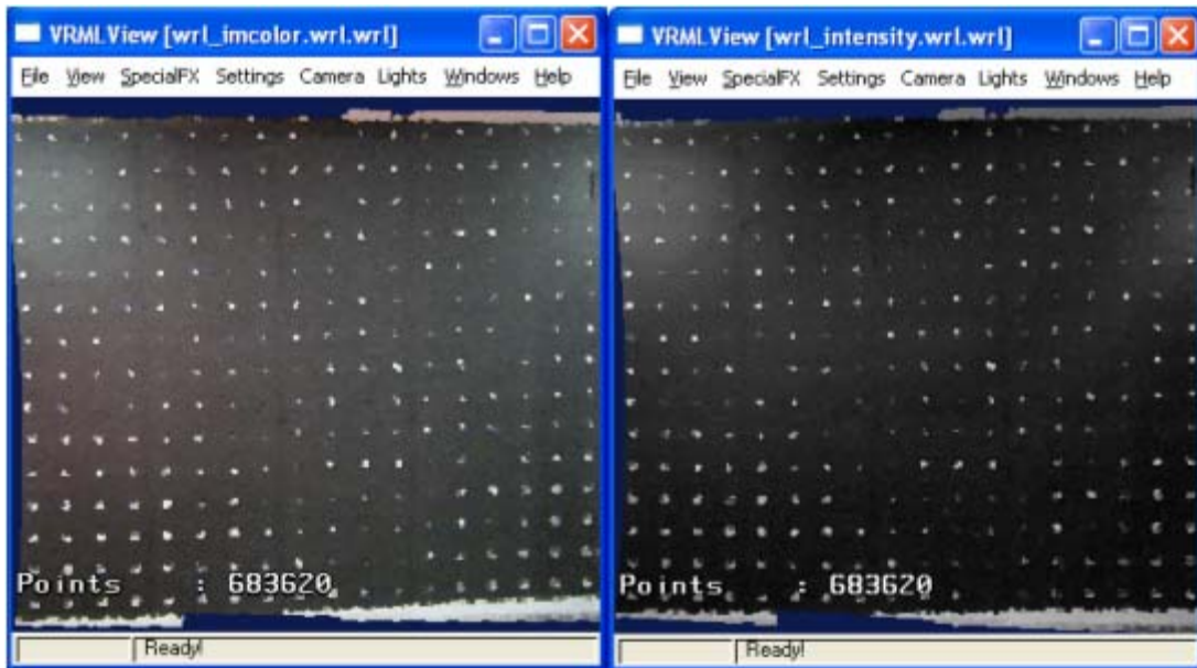
Şekil 7. Lazer tarama noktalarının kamera renkleri (solda) ve yansıma değerleri ile görüntüsü (sağda).
