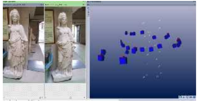
ekil 3. PM yazılımında resim çekim açıları ve kullanılan kontrol noktaları
