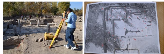
Şekil 7. Arazi ölçüm işlemi ve krokisi
