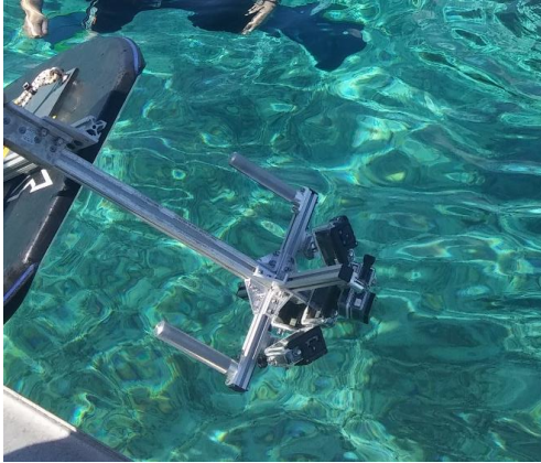
Şekil 4. 5 adet GoPro kamerasından oluşan sualtı kamera sistemi.
