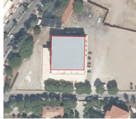
Şekil 8. 2600 metreden son dönüşten elde edilen SYM'nin maksimum 9x9 filtresinden geçirildikten sonra oluşturulan gerçek orto görüntü
