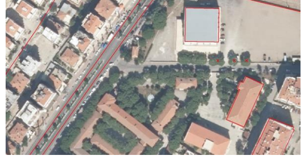
Şekil 6. Görüntü eşleme ile oluşturulan SYM kullanılarak oluşturulan orto görüntü
