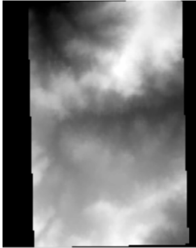
Şekil 1. Stereo Modelden otomatik olarak oluşturulan TIN formatındaki SYM'nin raster görüntüsü.
