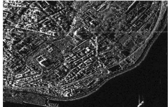
(b) Frost Filtresi Uygulanmış Görüntü Şekil 3. Filtreleme Etkisi
